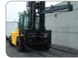
Vorkversteller met sideshift en ladingstabilisator
