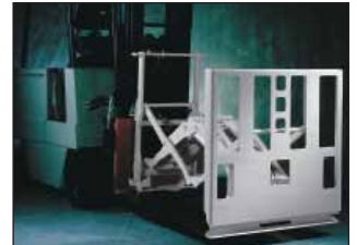
4. Damit ist der QFM Push/Pull bereit, Lasten mittels slip-sheet aufzunehmen.
