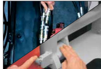
2. Die hydraulischen Schnelltrennkupplungen anschließen. 3. Die unteren Haken verriegeln.
